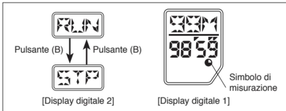
4. Allo scadere del tempo il display digitale 2 visualizza END (fine) e viene emesso il segnale acustico di tempo scaduto per 5 secondi.
