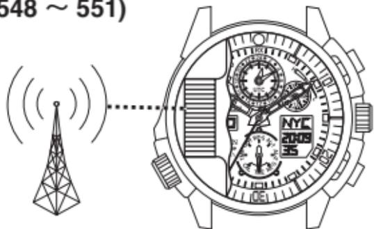
All'interno dell'orologio, in corrispondenza delle ore 9:00, vi è un'antenna per la ricezione dei segnali radio.
