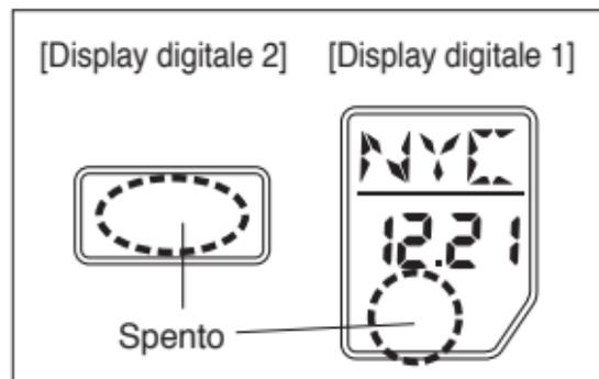
4. Ad ogni pressione del pulsante in alto a destra (B), cambia la posizione di correzione. La nuova posizione di correzione inizia a lampeggiare.
