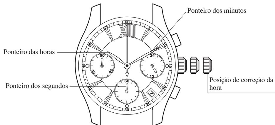
Caso a coroa seja do tipo aparafusada, afrouxe o parafuso girando a coroa para a esquerda antes de operar a coroa, e depois de retornar a coroa para a posição normal após uma operação, gire a coroa para a direita enquanto a empurra firmemente para reapertá-la.
