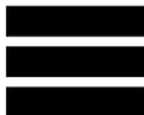
Completamente caricata (Sebbene l'indicatore indicherà il livello 3 quando viene raggiunta la carica completa, esso cambierà al livello 2 immediatamente dopo.)
