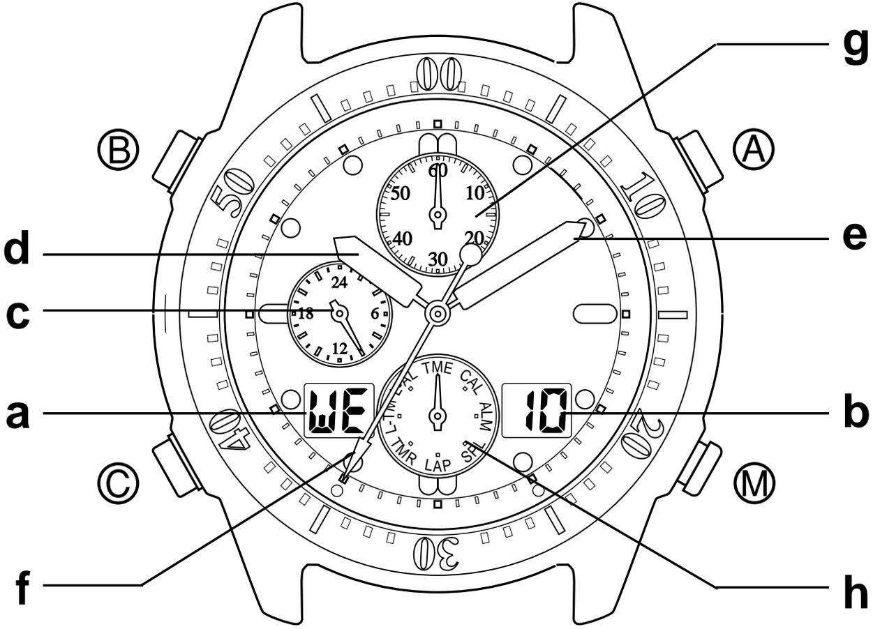
Cette montre est en réalité une montre combinée intégrant deux sortes de fonctions chronographe et de chronométrage qui permettent d'effectuer les opérations de chronométrage les plus divers pendant des compétitions en marge des fonctions d'indication habituelles de l'heure, du calendrier et de la sonnerie.
